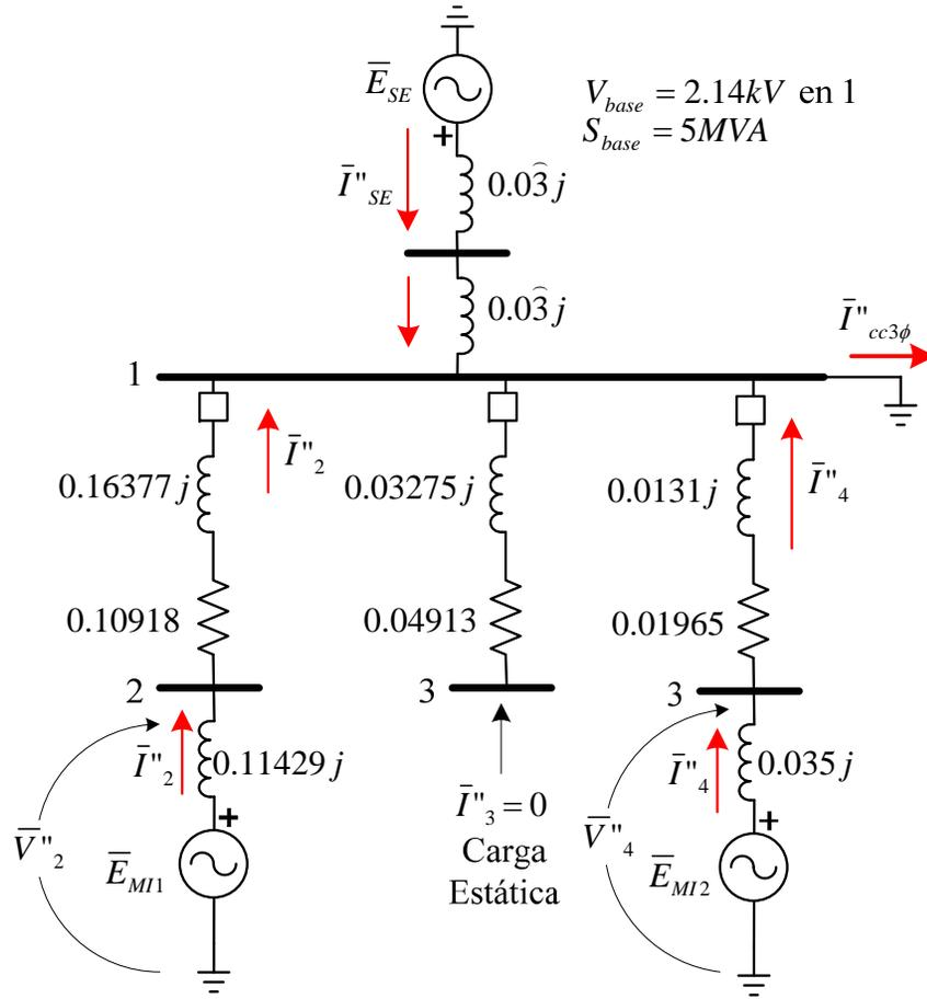
$$\bar{I}''_{cc3\phi} = \bar{I}''_2 + \bar{I}''_4 + \bar{I}''_{SE}$$
