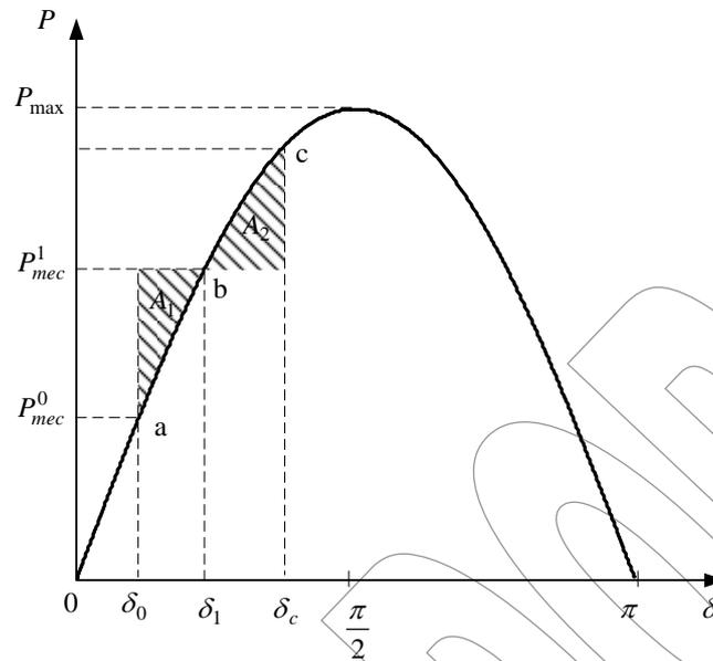
**Figura 4. Diagrama de Potencia-Angulo para un cambio en la Potencia Mecánica**
