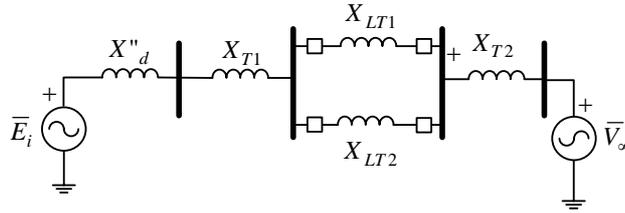
**Figura 2. Diagrama de reactancias del sistema mostrado en la Figura 1**
