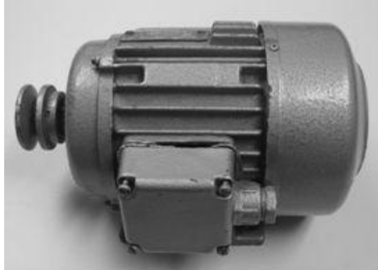
Figura 2. Foto con la vista lateral de la máquina de inducción de 180 Watt, 254/440V
