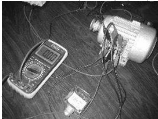
Figura 8. Montaje para el ensayo de la medición de la resistencia del estator
