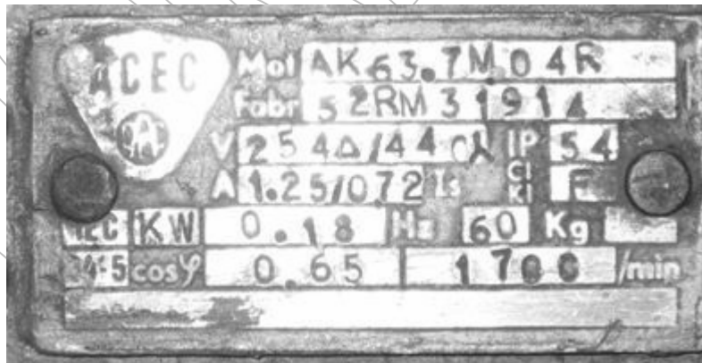
Figura 1. Fotos de la placa con datos de la máquina de inducción de 180 Watt
