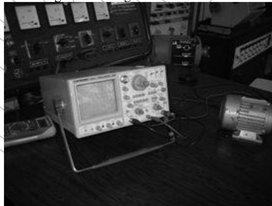
Figura 14. Montaje para el ensayo en vacío
