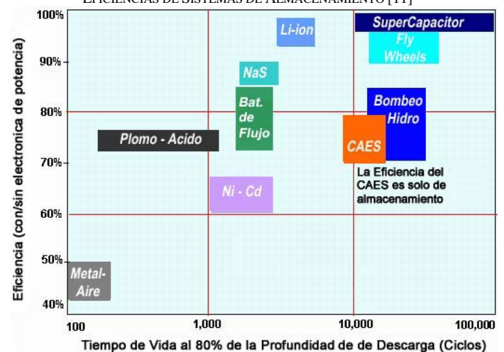
FIGURA 3 EFICIENCIAS DE SISTEMAS DE ALMACENAMIENTO [11]
