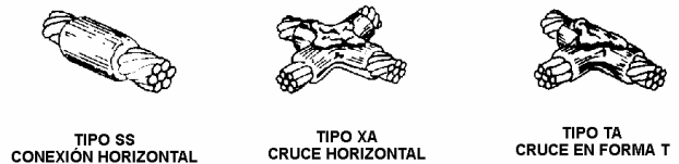
Fig. 5. Tipos de soldaduras, conductor a conductor
