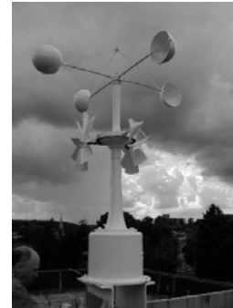
Figura 2. Anemómetro de Copas de Robinson
